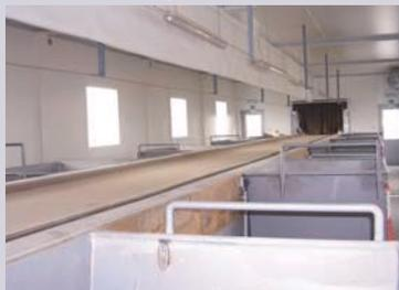
2. Tri des déchets volumineux à la pelle mécanique. Pour les autres déchets, chargement d'un tapis d'alimentation puis passage dans un trommel (séparation des déchets en fonction de leur taille).
