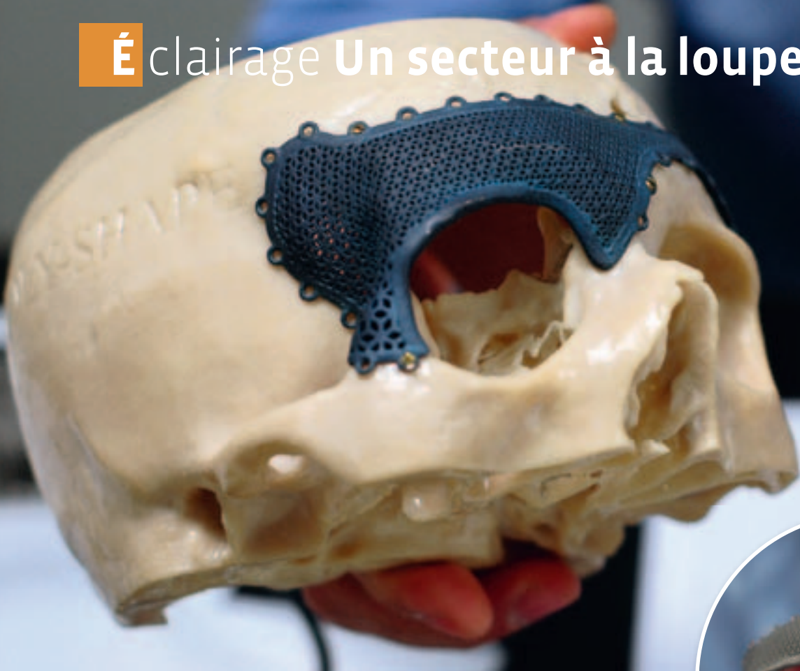
Exemple de pièce métallique 3D produite par Poly-Shape dans le domaine de la reconstruction maxillo-faciale.
