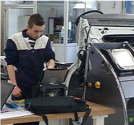
Un véhicule en panne ou accidenté et le mécanicien entre en scène. Il procède à l'examen du véhicule, fait des tests sur les divers éléments mécaniques, électriques ou électroniques, puis interprète les résultats obtenus. Une fois le diagnostic établi, il démonte les organes défectueux, remplace les pièces endommagées ou les remet en état. Puis, il effectue les différents réglages et procède aux essais avant les dernières mises au point.
